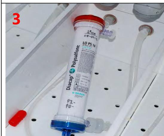
A continuación, cierre la otra puerta del compartimento externo con la cubierta que se produzca a través de retrolavado UF inversa. Deje retrolavando durante al menos 10 minutos o el tiempo necesario para
